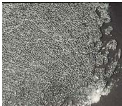
1 pav. Grūdinto stiklo dūžio testas.
